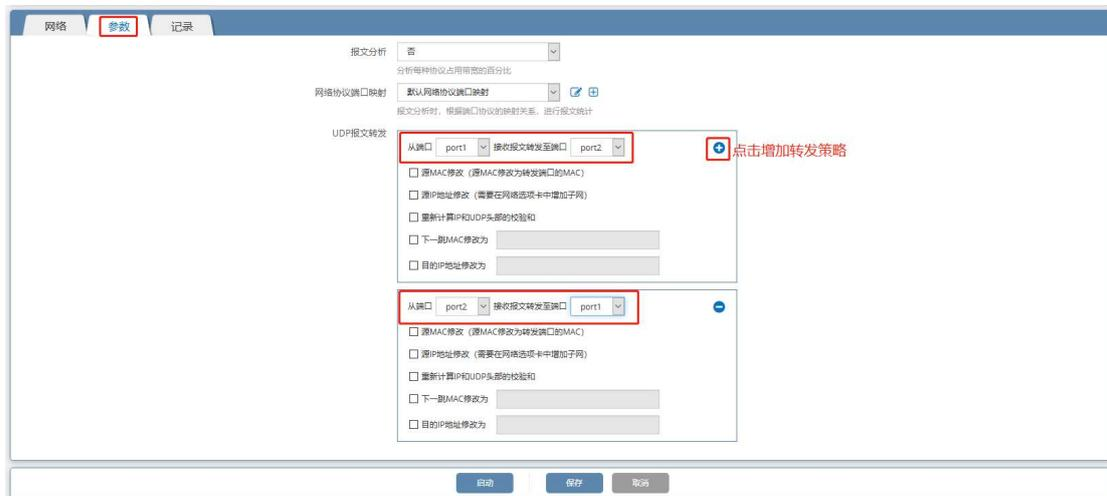
5) 在参数->用例参数页面，配置用例运行参数。如转发包数、报文分析、网络协议端口映射等。
