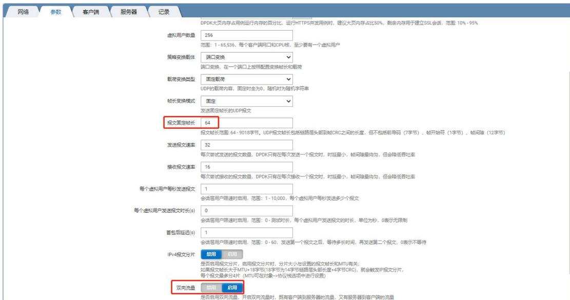
5. 修改完参数后点击启动，用例开始运行，跳转到监控页面，测试用例会自动保存在“UDP/TCP->UDP->吞吐”测试类型下。
