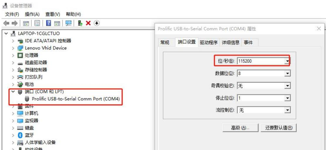
2. 把 USB 转串口线的另一端插到 16F 设备的九针串口上，在管理电脑上用终端程序（比如 SecureCRT）连接串口，接收 16F 的串口输入和输出信息。Supernova 使用的串口波特率是 115200，串口设置如下：
