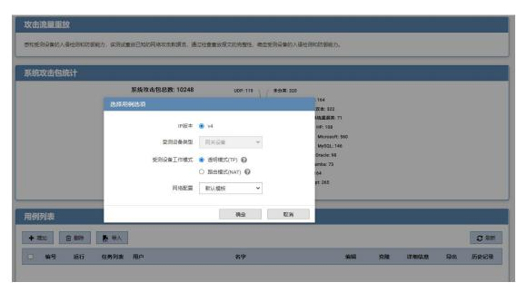
3)点击确定,进入用例配置界面,配置子网信息。受测设备工作模式为透明模式,两边子网可以配置同一子网。
