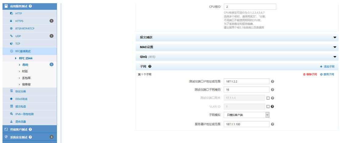
有 ping 参与，需要配置 ip 地址，服务器 ip 地址填写成转包机的 ip
