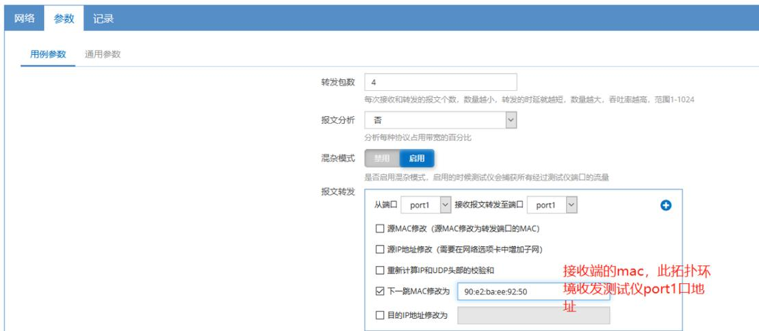
配置结束，先启动转包机，然后在启动收发测试仪
